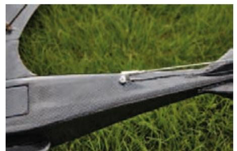
Die einzige Abweichung von der Bauanleitung: Das stehend eingebaute Höhenruder-Servo verhindert die Schwächung des Leitwerksträgers durch die Anlenkung.
