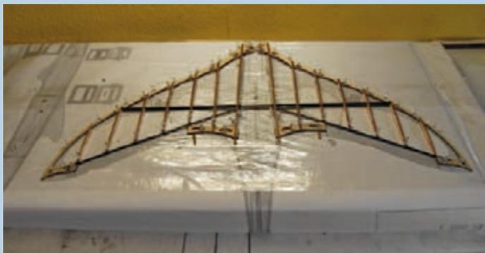
Bei einigen Teilen wird in der Anleitung auch auf die Notwendigkeit der Nachbearbeitung hingewiesen. Dies betrifft z. B. die Flächenbeplankung und die Rippen-Aufleimer. Die entsprechenden Teile liegen mit leichtem Übermaß bei, um eine genaue Passung zu gewährleisten.
